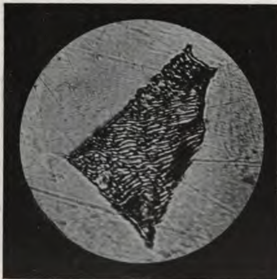
Fig. 135. Material wie Fig. 134. Einzelne Perlitinsel in 1500facher lin. Vergr. umgeben von Ferrit.
